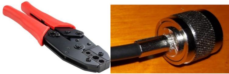
Figura 7. Pinza de ponchado y cable finalizado.
