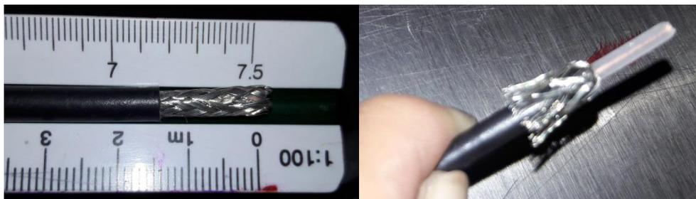
**Figura 3.** Cable coaxial sin cubierta exterior.
