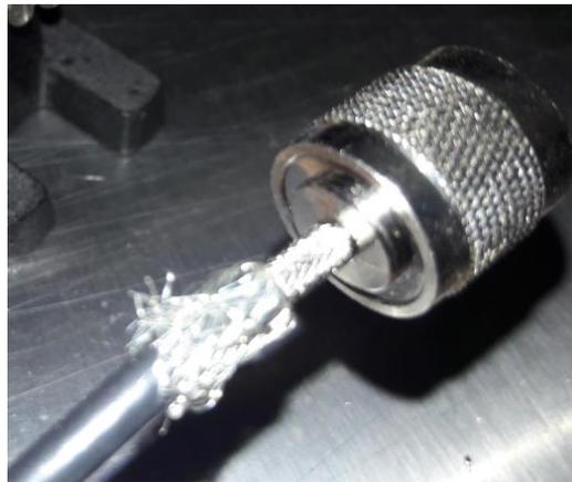
**Figura 5.** Inserción del conector tipo N.
