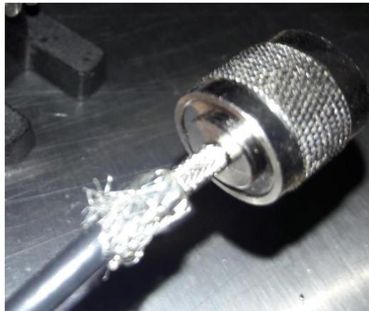
**Figura 5.** Inserción del conector tipo N.
