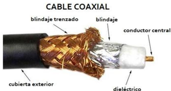
Figura 1. Partes del cable coaxial.
