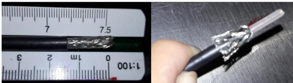
**Figura 3.** Cable coaxial sin cubierta exterior.
